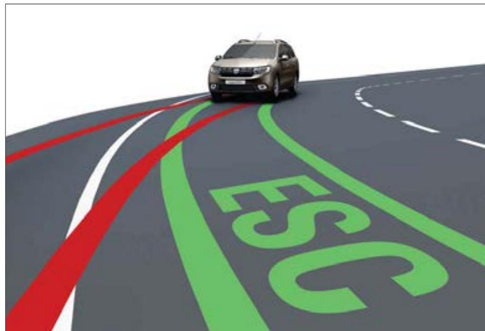
**ESC** : Il permet de stabiliser la trajectoire du véhicule en cas de perte d'adhérence dans les virages en agissant sur la répartition du freinage et le régime du moteur.
