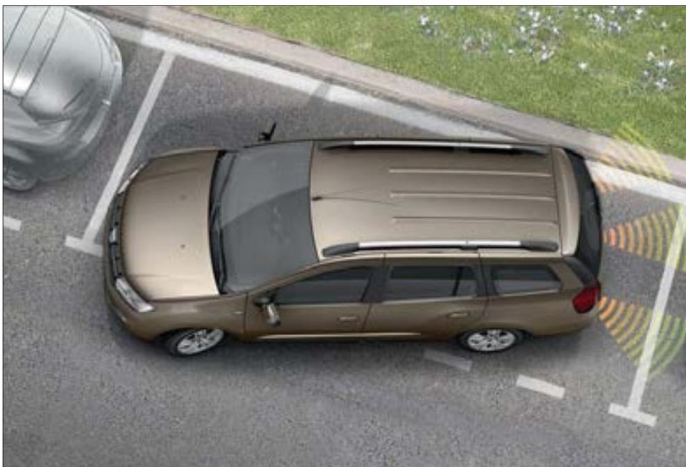
**Aide au parking arrière\*** : Elle avertit le conducteur de la présence d'obstacles situés à l'arrière de son véhicule par une séquence de « bips ». Et pour encore plus de confort et de sécurité, vous pouvez choisir d'y coupler une caméra de recul.
